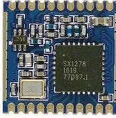
EL1669D 是一款采用源自军用战术通信系统的 LoRa 调制技术设计的模块，完美解决了小数据量在复杂环境中的超远距通信问题，默认频段为 433MHz。
